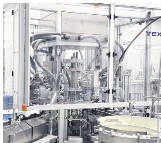
Produktion hinter Glas: Hinter Schleusen und Druckkaskaden laufen die Kartuschen vollautomatisch vom Band. Foto: Spilok
