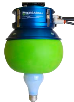
Ein Job für Weicheier: Der sandgefüllte »Versaball« schraubt sogar zerbrechliche Glühlampen ein.
