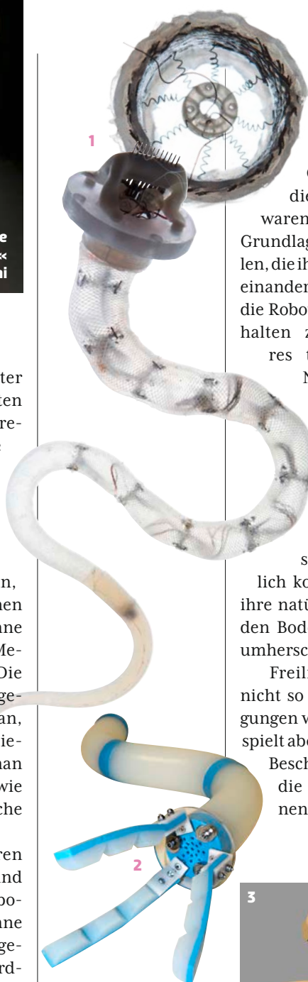
1 Innenleben: Künstliche Muskeln aus Draht treiben die »Octopus«-Tentakeln an. 2 Ihre Steuerung ist Vorbild für einen Greifarm, der alten Menschen beim Waschen hilft. 3 Er wird an der Wand einer Duschkabine befestigt und schrubbt den sitzenden Patienten auf Befehl ab.
