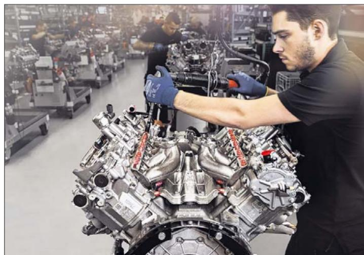
Der Motorenbauer begleitet bei AMG den Motorblock von der ersten bis zur letzten Schraube. Foto: Mercedes-AMG
