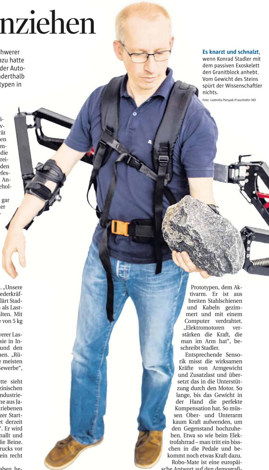
Prototypen, dem Aktivarm. Er ist aus breiten Stahlschienen und Kabeln gezipfelmert und mit einem Computer verdrahtet. „Elektromotoren verstärken die Kraft, die man im Arm hat“, beschreibt Stadler.
