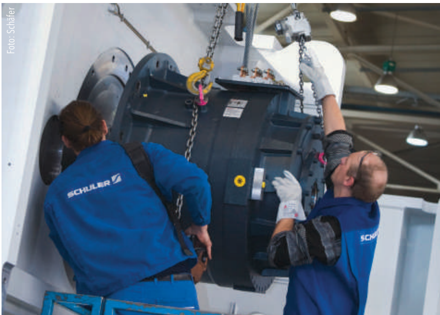
Montage eines kraftsparenden Servomotors an einer Großpresse. Die Pressen kommen in der Automobilindustrie zum Einsatz und sind wahre Kolosse aus Stahl und Gusseisen.
