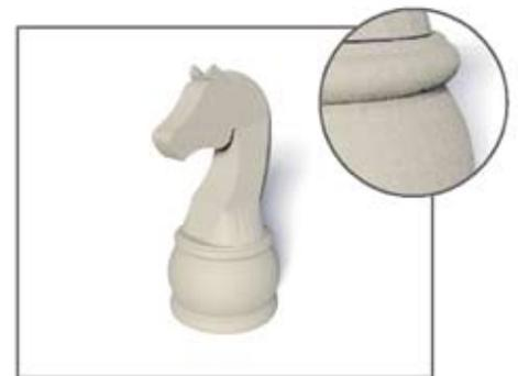
8. Das Bauteil ist fertig. Seine Oberfläche ist noch rau, sie kann aber poliert und lackiert werden.
