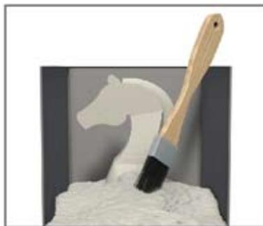
7. Ist das Bauteil fertig, wird das nicht verschmolzene Pulver entfernt. Das meiste davon kann wiederverwendet werden.
