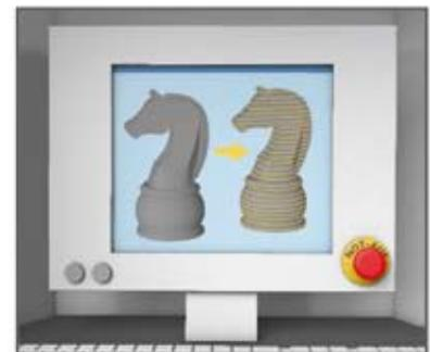
1. Die zuvor am Computer erstellten Daten für den Bauplan werden eingelesen. Die Laseranlage errechnet daraus, wie dick die einzelnen Pulverschichten sein müssen.
